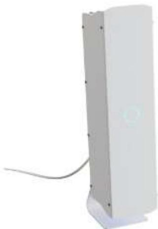
Облучатель-рециркулятор воздуха ультрафиолетовый бактерицидный "ОВУ-01" предназначен для обеззараживания воздушной среды в помещениях I-V категорий ЛПУ, прочих учреждений и организаций, жилых помещений за счет обработки проходящего через него воздуха ультрафиолетовым излучением от УФ-источника размещенного в закрытом корпусе.
