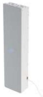
Облучатель-рециркулятор воздуха ультрафиолетовый бактерицидный "ОВУ-05" предназначен для обеззараживания воздушной среды в помещениях I-V категорий ЛПУ, прочих учреждений и организаций, жилых помещений за счет обработки проходящего через него воздуха ультрафиолетовым излучением от УФ-источника размещенного в закрытом корпусе.
