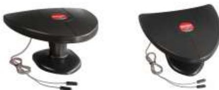
Всеволновая комнатная антенна предназначена для приема телевизионных программ в цифровом формате вещания. Антенна основана на классической логопериодической структуре для каналов ДМВ и имеет гибкий дипольный элемент для каналов МВ. Усилитель новой конструкции практически не подвержен негативному влиянию помех от импульсных блоков питания современной бытовой и компьютерной техники.
