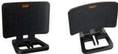
Компактная антенна «BAS-5354-USB Азимут» предназначена для приёма цифрового DVB-T2 вещания в широком диапазоне частот. Антенна оптимально подходит для размещения на подоконнике или любой горизонтальной поверхности, благодаря устойчивой пластиковой подставке.
