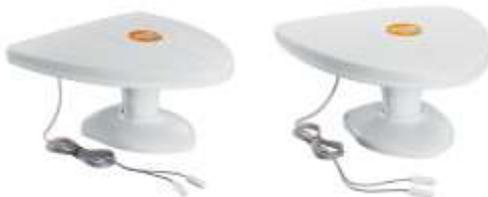
Антенна РЭМО BAS-5334-DX Фазан предназначена для использования в зоне устойчивого приема телевидения. Устройство активного типа со встроенным усилителем эффективно улавливает как аналоговые, так и цифровые сигналы стандарта DVB-T2. Специальная грибовидная форма корпуса исключает возникновение эффекта экрана при размещении на металлической полке или подоконнике, поэтому минимизирована вероятность появления помех.
